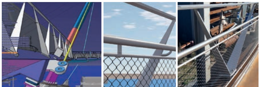
Bild 9. Räcke och infästningar för kablar har detaljutformats med hjälp av färgsatta, precist mått-satta modeller för att sedan studeras i mera realistiska, renderade bilder och i form av fullskaleprototyper som togs fram av PEAB/Stål & Rörmontage.
