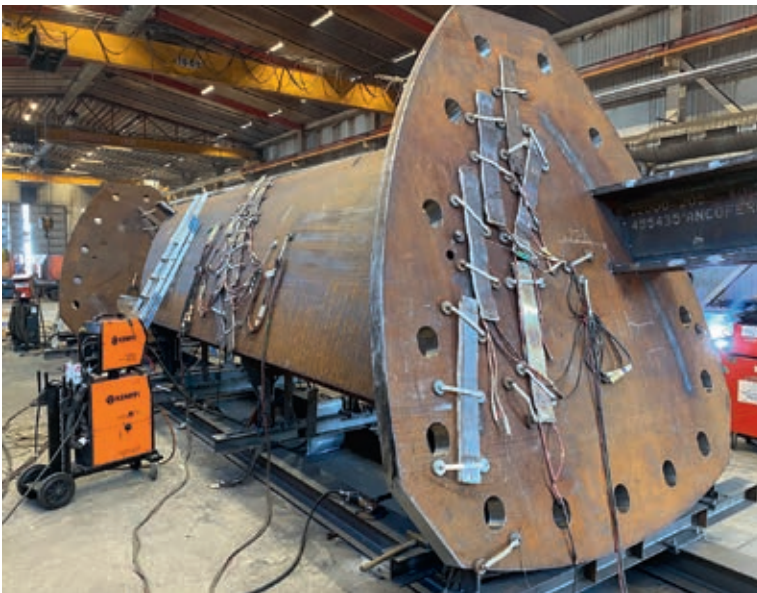
Bild 11. Svetsning av pylon i 460 NL/ML + Z35 material som kräver förhöjd arbetstemperatur på 140 grader vid start av svets.
